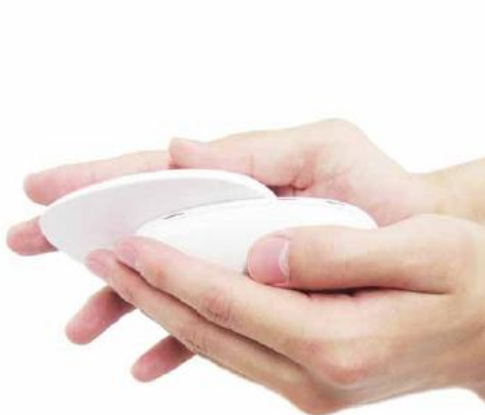
本体を上下にずらす反復運動で充電をしているシーン
