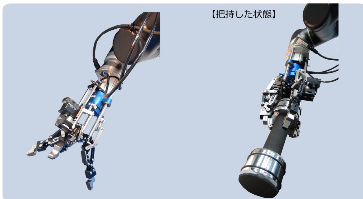
図1 可変剛性機構付き3本指ロボットハンド「D-Hand Type R」
