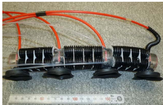
➤開発中の管内走行ロボット (空気圧ゴム人工筋アクチュエータを適用)
