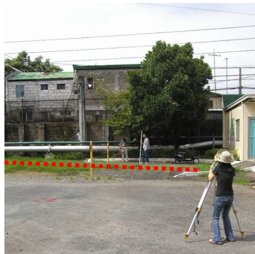
繰返し水準測量による 断層クリープのモニタリング (赤線部分が断層位置)
