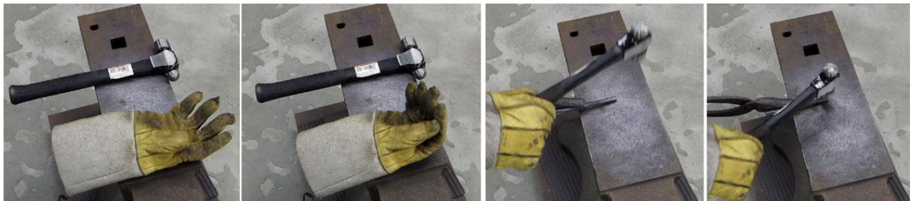
図4 F-handに耐熱手袋をかぶせてハンマーで鉄棒を叩く様子 (鍛造作業を想定したテスト)
