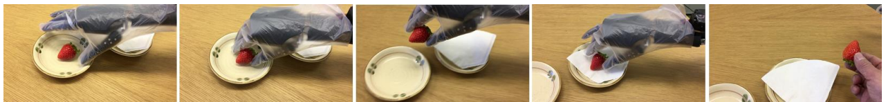
図3 F-handにポリ手袋をかぶせてイチゴをつかむ様子
