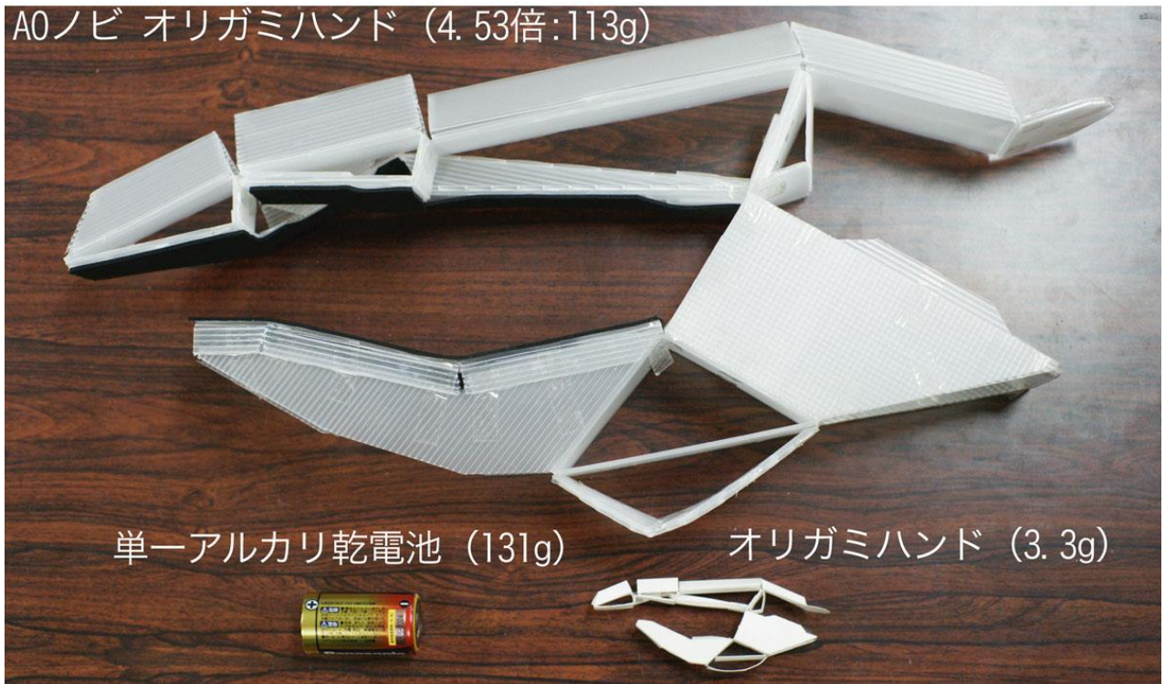
図12 A0ノビサイズに拡大印刷し4.53倍で作成したオリガミハンド (プラスチック段ボールで製作、滑り止めゴムを貼るなど一部改良済み)
