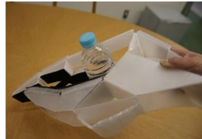
拡大サイズのオリガミハンドで500ml ペットボトルをつまみ上げる様子
